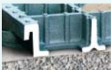
**Hohe Eigentragfähigkeit:** Die Gitterplatten des TTE®-Systems haben eine massive Struktur aus unverrottbarem Recycling-Kunststoff. Das Eigengewicht von rd. 21 kg/m<sup>2</sup>, die enorme Druckfestigkeit von 12 N/mm<sup>2</sup>, die trapezförmigen Stege von 9-10 mm Stärke, sowie die T-förmige breite Auflagefläche an der Unterseite verleihen den Gitterplatten eine außergewöhnliche Eigentragfähigkeit. Eine TTE®-Schicht\* von nur 10 cm reicht aus für eine optimale Befestigung Ihres Reitplatzes.
