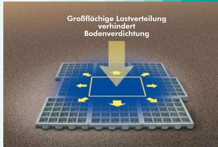
Durch die 4-seitige Verzahnung wird punktuelle Last großflächig verteilt, Verdichtungen werden minimiert.
