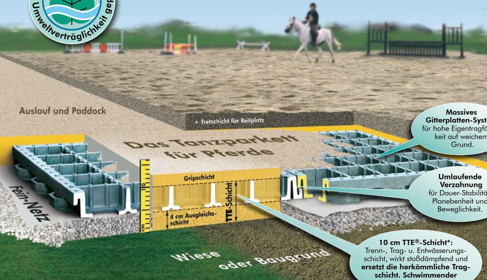
**Massives Gitterplatten-System** für hohe Eigentragfähigkeit auf weichem Grund.
